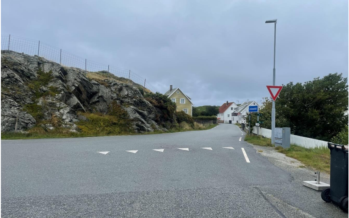
Figur 15: Kjørende fra Langøyveien har vikeplikt der de møter fv. 4692 Leiasundveien. Kilde: Kvitsøy kommune, september 2024.
