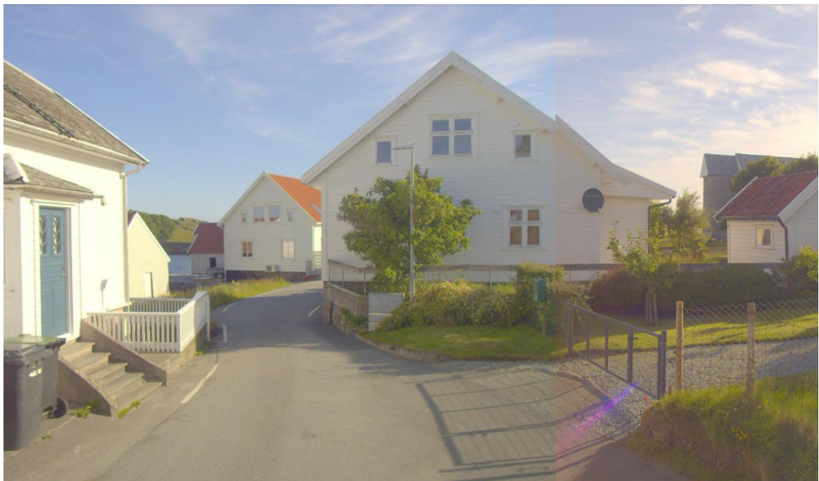
Figur 5: Eksempel på dårlig sikt med boliger tett inntil veggen langs Fv. 4692 (tidl. Fv. 555). Utklipp fra vegkart.no
