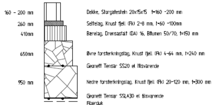
Prinsipp for tilkøbling mot eks. veioverbygning - I lengderetning, snitt
